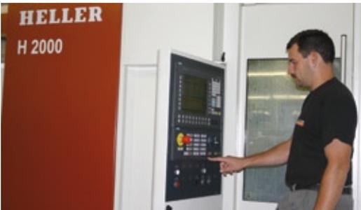
Im Grundumfang der CNC ist die integrierte Sicherheitstechnik, die Betriebsarten 2 und 3 sowie das zeitsparende Werkzeugrüsten während der Spindellaufzeit bereits enthalten.
